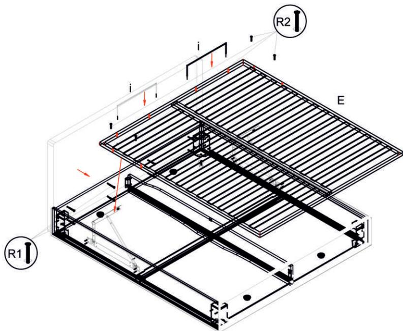
13. С помощью винтов с прессшайбой M8X40 и гаек M8 прикрутить решетку (E) к подъемным механизмам (шайбы M8 не использовать).
