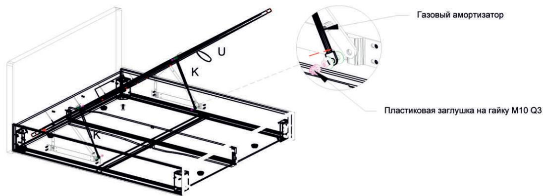
15. Приподнять решетку примерно на угол 40-45° . Установить газовые амортизаторы(K). Закрепить газовые амортизаторы с помощью гаек M10(Q4).
