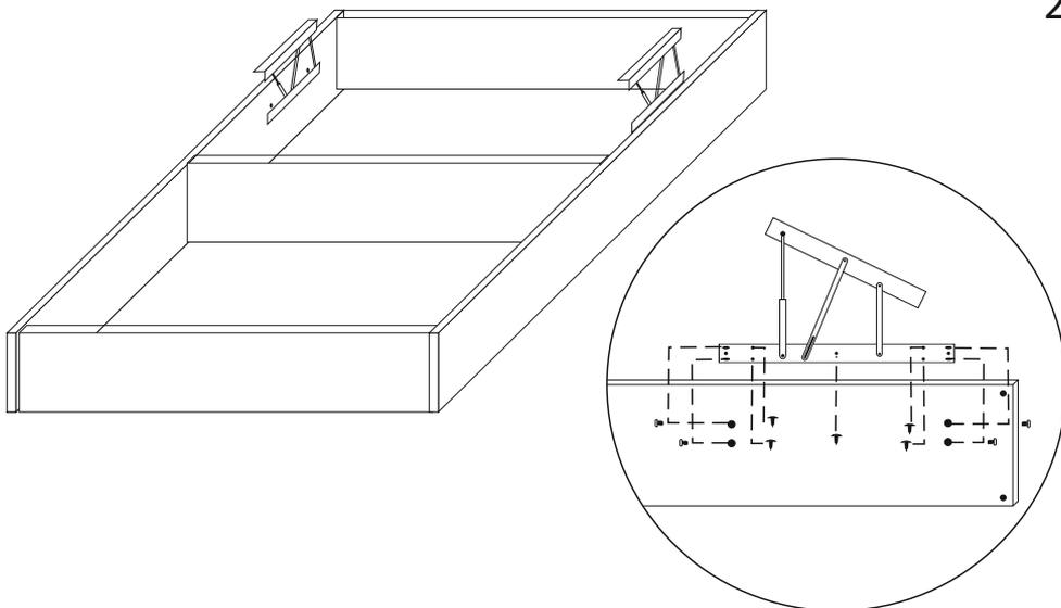
3. Крепится подъемный механизм с применением винтов (3) которые вкручиваются в пластиковые футорки, врезанные в боковины ящика
