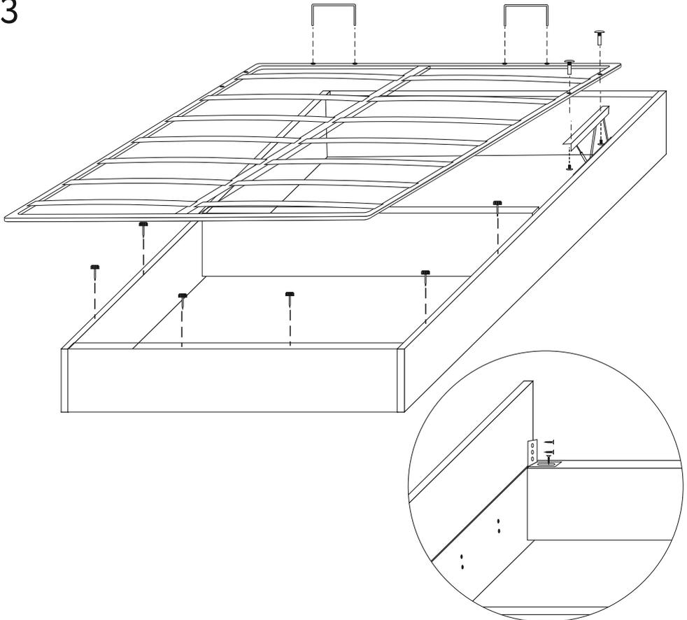
4. Ортопедическая решетка крепится к подъемному механизму межсекционными стяжками (4), далее выравнивается относительно ящика. В свободные отверстия механизма закручиваются короткие саморезы (5). Обязательно! Вбиваем гвозди демпферы (7) в кромку ящика как на схеме.
