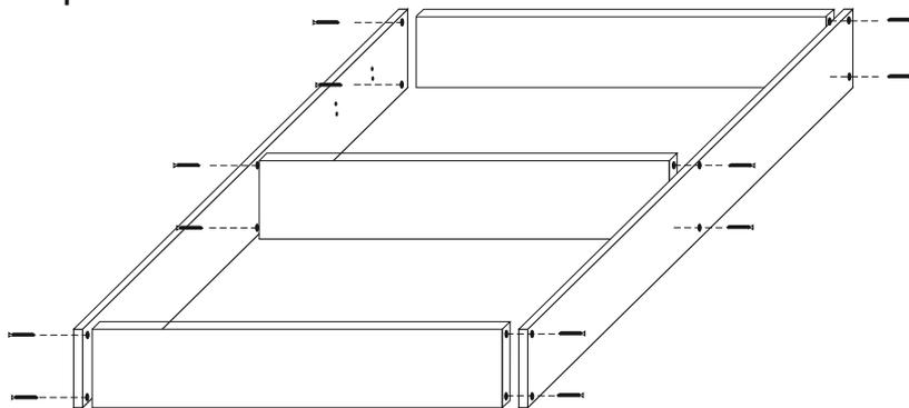
1. Стенки ящика ставятся обработанной кромкой вверх и скрепляются с помощью евровинтов (1), затем отверстия закрываются заглушками (2).
