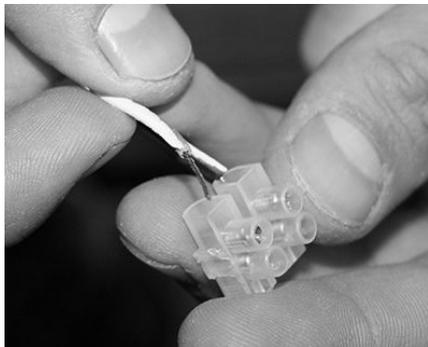
9. Концы проводов соедините с 12-вольтовыми выходами электронного трансформатора с помощью клеммника.
