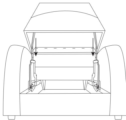
Надеваем направляющие спинки на механизм.
